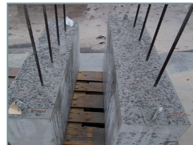
Til fremstilling af kolde støbeskel blev 5-10 mm af tilslaget fritlagt ved sandblæsning.
