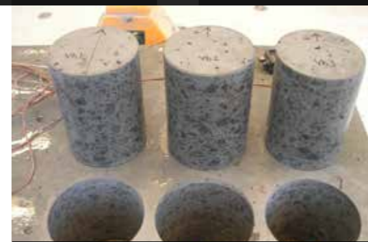
De udborede kerner til frostprøvning
